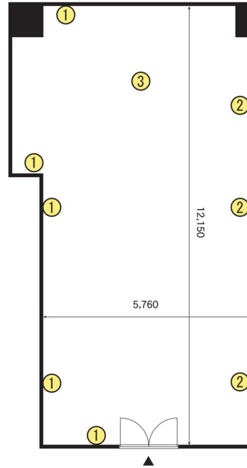
数字・・・平行コンセント【1回路100V 1.5Kw】同数字=1回路
