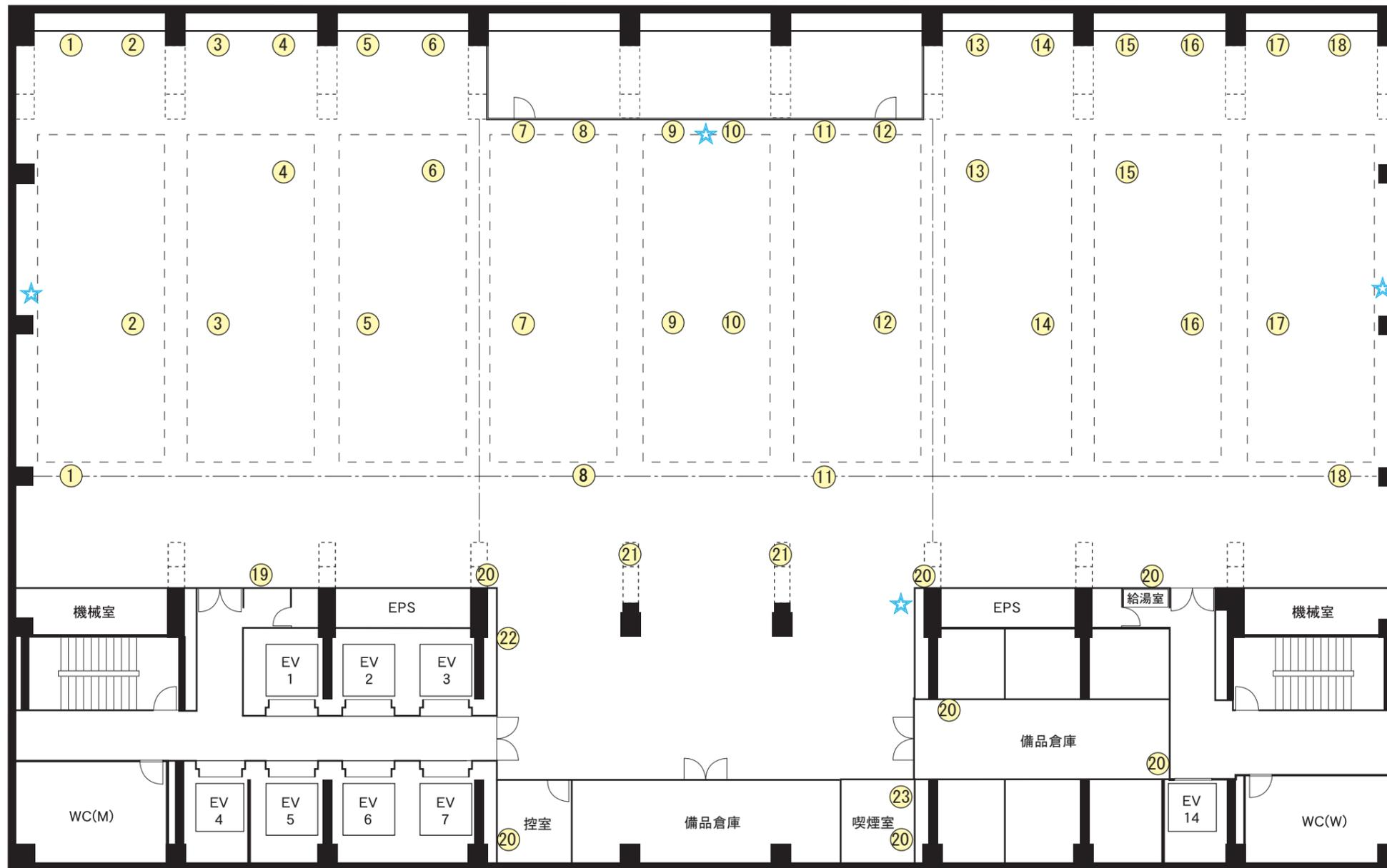
数字・・・平行コンセント【1回路100V 20A】同数字=1回路
